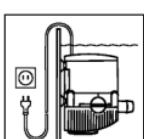
**Pour votre propre sécurité, il est recommandé de donner une forme en col de cygne au câble de raccordement afin d'éviter que de l'eau coulant éventuellement le long du câble ne pénètre dans la prise de courant.**
