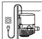
**Voor uw eigen veiligheid is het aan te bevelen met de aansluitkabel een druppellus te vormen die verhindert dat eventueel langs de kabel lopend water in het stopcontact geraakt.**
