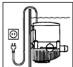
Saját biztonsága érdekében ajánlatos a hálózati vezetéken egy csöpögőhurkot képezni, amely megakadályozza, hogy az esetlegesen a kábel mentén folyó víz a csatlakozóaljzatba jusson.
