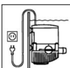
For Deres egen sikkerheds skyld anbefales det at danne en løkke med ledningen, der således forhindrer, at vand, som eventuelt løber langs med ledningen, drypper ned i stikkontakten.
