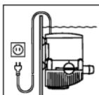
Zu Ihrer eigenen Sicherheit empfiehlt es sich, mit dem Anschlusskabel eine Tropfschlaufe zu bilden, die verhindert, dass eventuell am Kabel entlang laufendes Wasser in die Steckdose gelangt.
