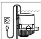
Pre vašu vlastnú bezpečnosť doporučujeme vytvoriť na káble slučku pre odkvapkávanie vody, ktorá zamedzí, aby sa eventuálne dostala voda po káble do sietovej zásuvky.
