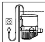
Si utiliza un enchufe distribuidor o una fuente de alimentación externa, asegúrese de colocarla encima de la conexión eléctrica de la bomba.
