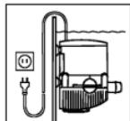
为了您个人的安全，建议您用电源电缆制成一个弧形滴水环，这样能防止流水会沿着电缆进入电缆插座中。
