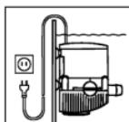
Para sua própria segurança recomendamos fazer um laço de gotejamento com o cabo de conexão de modo a impedir que água que eventualmente corra ao longo do cabo chegue à tomada.
