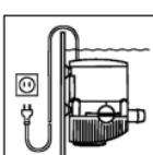
Za účelem zajištění Vaší bezpečnosti doporučujeme, abyste si na připojovacím kabelu vytvořili smyčku na skapávání vody z kabelu, tak aby netekla po kabelu až do zásuvky.
