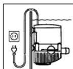
Dla własnego bezpieczeństwa zaleca się ułożenia kabla podłączeniowego z utworzeniem zwisającej pętli do spływu kropli wody, zapobiegając tym samym spłynięciu wody wzduł kabla do gniazdku wtykowego.
